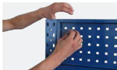
Die Sechskantschraube M8x20mm in die Lochungen des Ständerprofils und der Giterrückwand schieben. Dann von außen mit der Sechskantmutter verschrauben.
