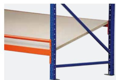
Um Schrägböden einzulegen, wird die hintere Traverse lediglich 5 Löcher höher als die vordere Traverse eingehängt.
